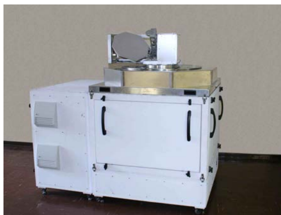
図 4. 完成した 30cm 可搬型サブミリ波望遠鏡
