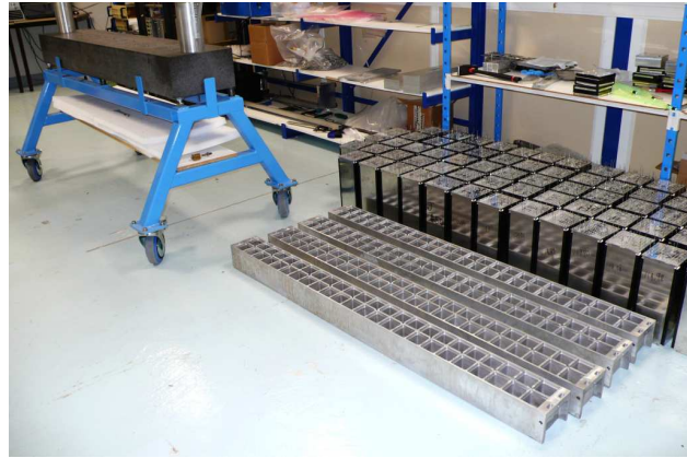
図 13: 筑波大からフランス・ナントに輸送した電磁カロリメータモジュールの一部（右奥）。
