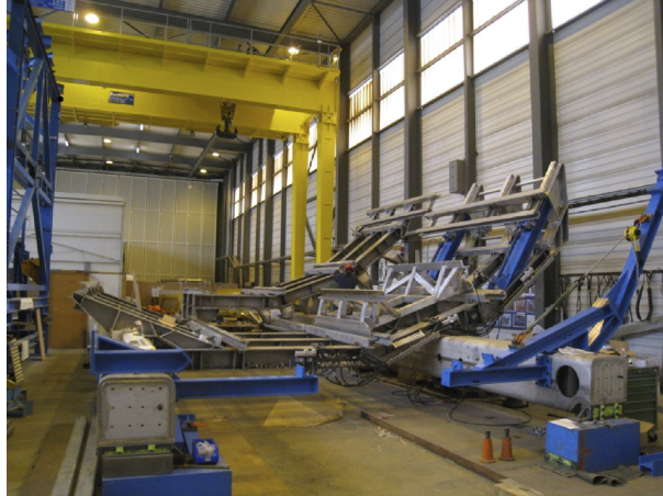
図 13: ALICE DCal 検出器のサポートフレーム
