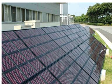
図2 (株)フジクラの DSC モジュールの屋外実証試験
