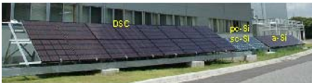
図 4 (株)フジクラによる色素増感太陽電池(DSC)モジュールの屋外実証試験の写真
