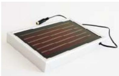
図 5 Dyesol 社で行われた耐久性試験用セル（面積<100cm<sup>2</sup>）と、それを用いた熱サイクル試験 50 サイクル後の性能
