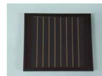
温湿度サイクル試験(A-2試験)による性能劣化はほとんど認められず、A-2試験については合格したとみなせる。
