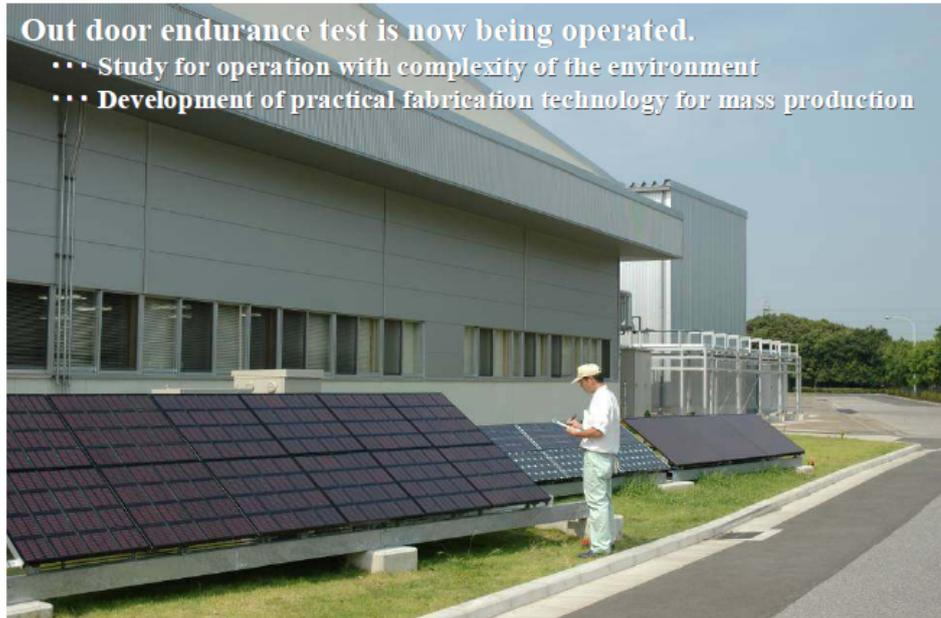
図8 (株)フジクラが行っている色素増感太陽電池の屋外実証試験の様子
