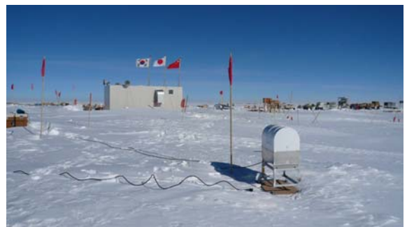
図2. ドームふじ基地での測定(手前ラジオメータ)
