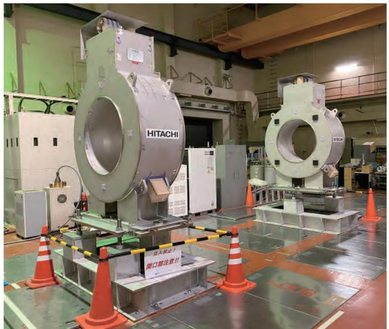
写真1 新装置Pilot GAMMA PDX-SC用の超伝導コイル据付風景
