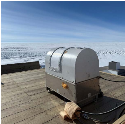
図1. ドームふじの220GHzでの大気の光学的厚さを測定したラジオメータ。
